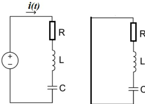
**Modelare.** Se va studia comportamentul circuitului în regim liber (regim propriu) atunci când condensatorul a fost încărcat anterior sub tensiunea generatorului și când se descarcă în bobină și rezistor din momentul  $t \geq 0$ .
